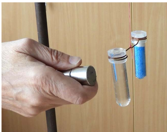
Obr. 10. Demonstrace paramagnetismu modré skalice.
