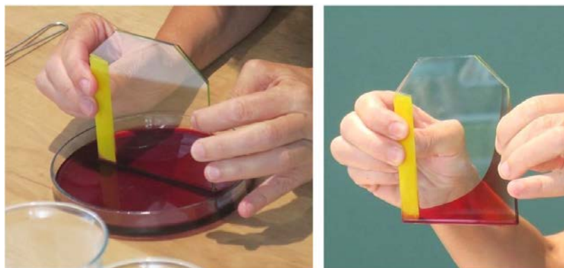
Obr. 7. Voda vzlínající v klínové vrstvě mezi dvěma skly.
