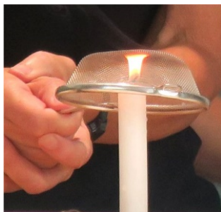
Obr. 5. Princip Davyho lampičky.
