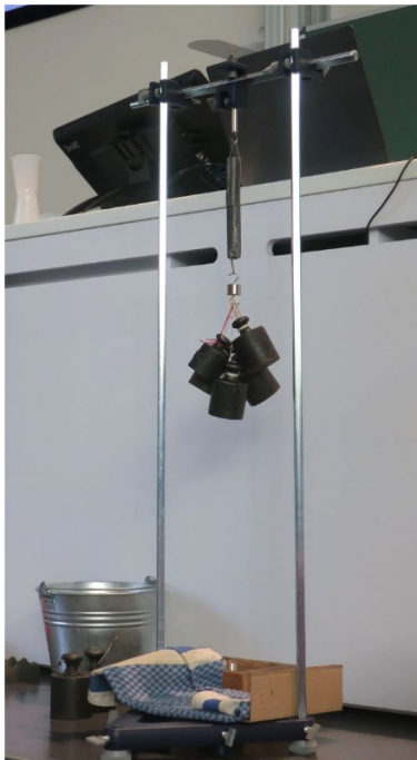
Obr. 2. Zatížené spojené kousky olověných trubek.
