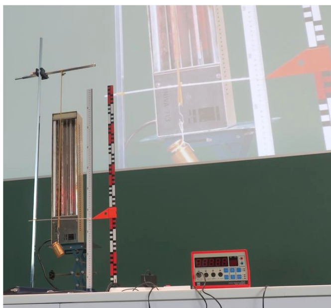
Obr. 3b. Demonstrace délkové „roztlačnosti“ gumy (v pozadí je detail promítaný z kamerového záznamu pokusu).
