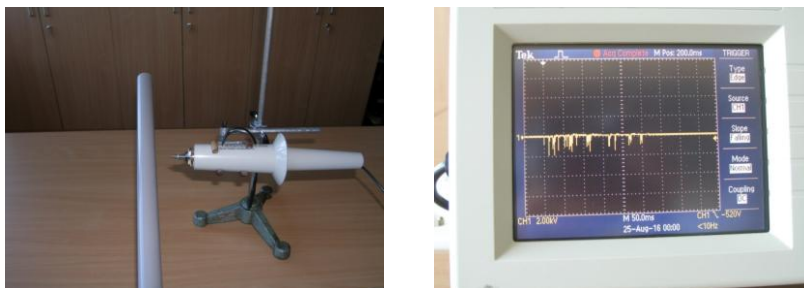
Obr. 3 Sršení náboje z nabitě novodurové tyče do hrotu sondy
