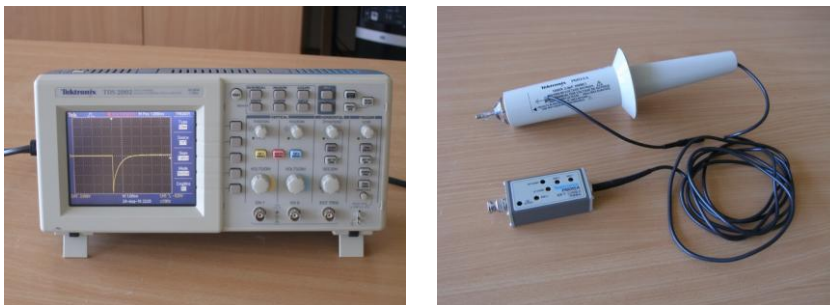
Obr. 1 Osciloskop a vysokonapěťová sonda
