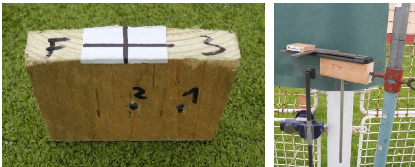
Obr. 5 Špalík s označením polohy těžiště zasažený již dvěma diabolkami (vlevo) a sestava se stojanem, opěrou a vzduchovkou ve svěráku (vpravo)
