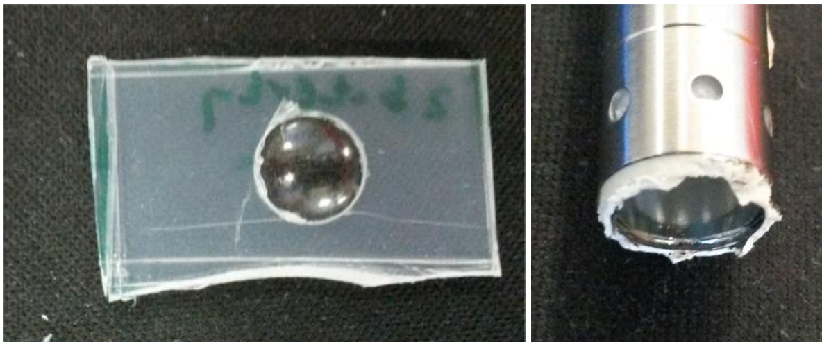
Obr. 2. Spojka pro výrobu lupy z mobilního telefonu. Spojku z levého obrázku stačí přilepit na kameru mobilního telefonu pomocí izolepy.
