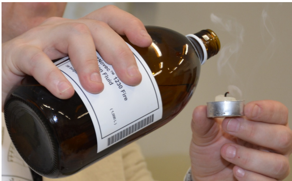
Obr. 1. Hašení zapálené svíčky parami hasiva NOVEC 1230
