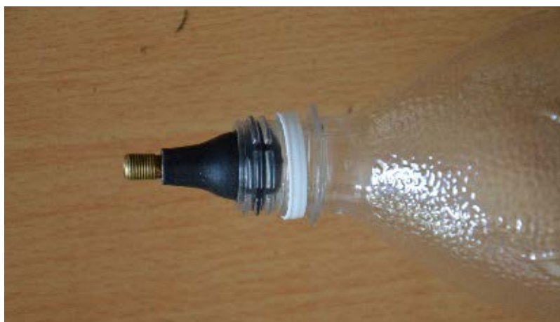
Obr. 3. Bezdušový ventilek TR415 v hrdle PET-lahve. Ventilek přesně pasuje do hrdla, proto je ideální pro odpaly vodních raket.
