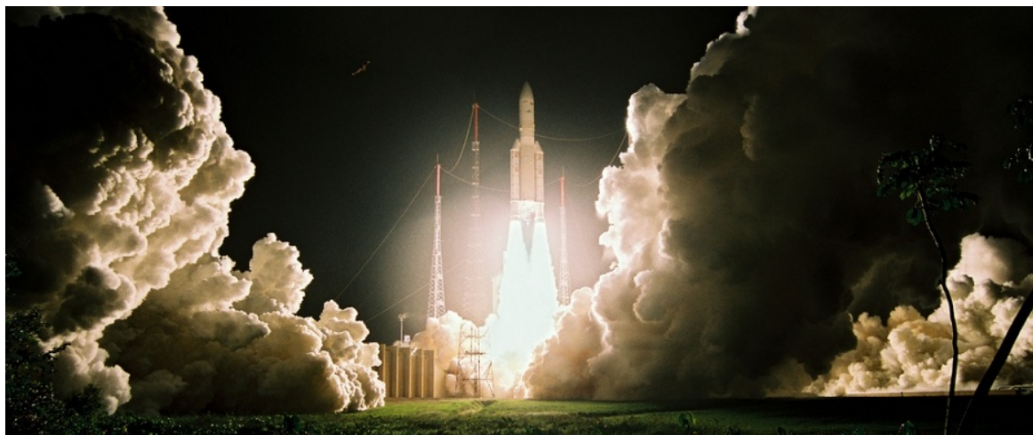
Obr. 1. Start rakety Ariane 5. Hořící palivo se pohybuje směrem dolů, proto se zbytek rakety pohybuje nahoru.
