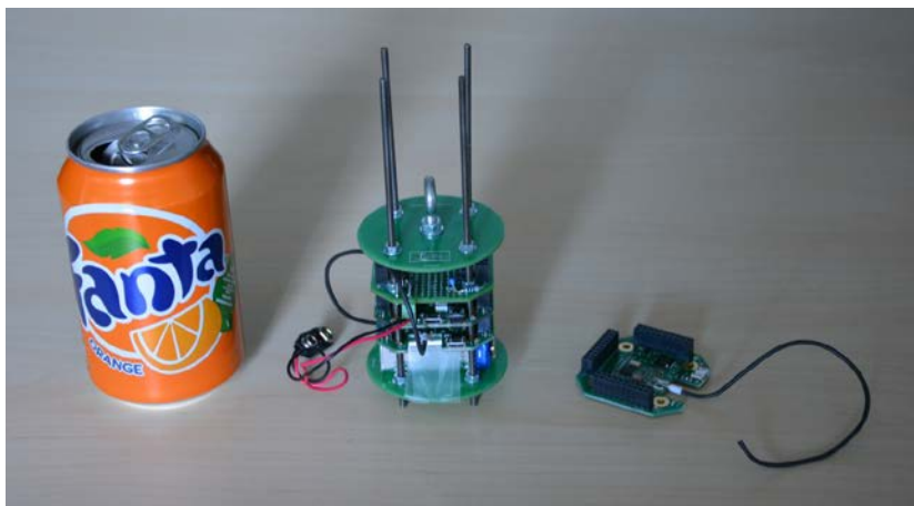
Obr. 5. Jedno z možných provedení CanSatu a přijímací antény. Pro srovnání je vedle satelitu plechovka od nápoje.
