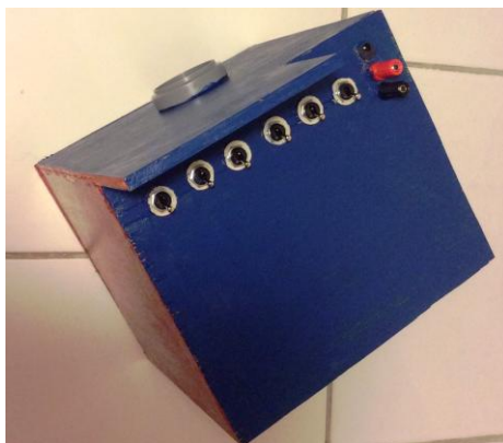
Obr. 7. Krabice k pozorování míšení světel nebo spektra světla
