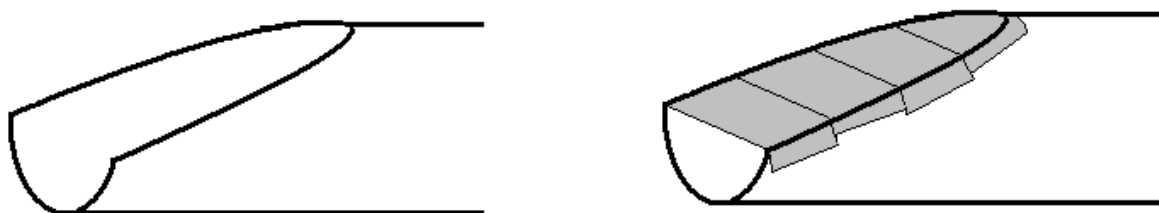
Obr. 2. Přelepením seříznuté trubky získáme bicí plochu.
