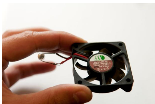
Obr. 1: LED připojená k ventilátoru
