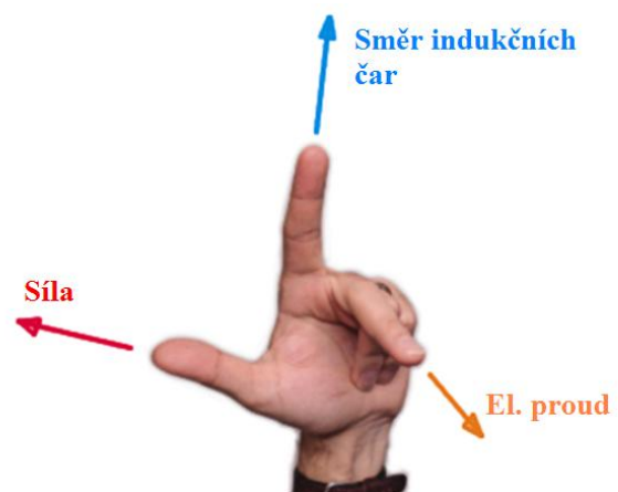
Obr. 7: Flemingovo pravidlo levé ruky
