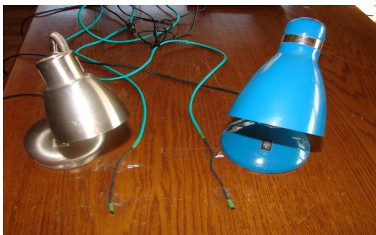
Obr. 3 – Ve stejné vzdálenosti od dvou zelených teploměrů jsou umístěny dva různé zdroje tepelného záření (stolní lampy se 100W a 60W žárovkou).
