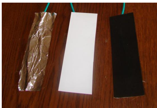
Obr. 1 – Tři zelené teploměry jsou přikryty alobalem, bílým a černým papírem. Ve stejné vzdálenosti od tří teploměrů je umístěn zdroj tepelného záření.
