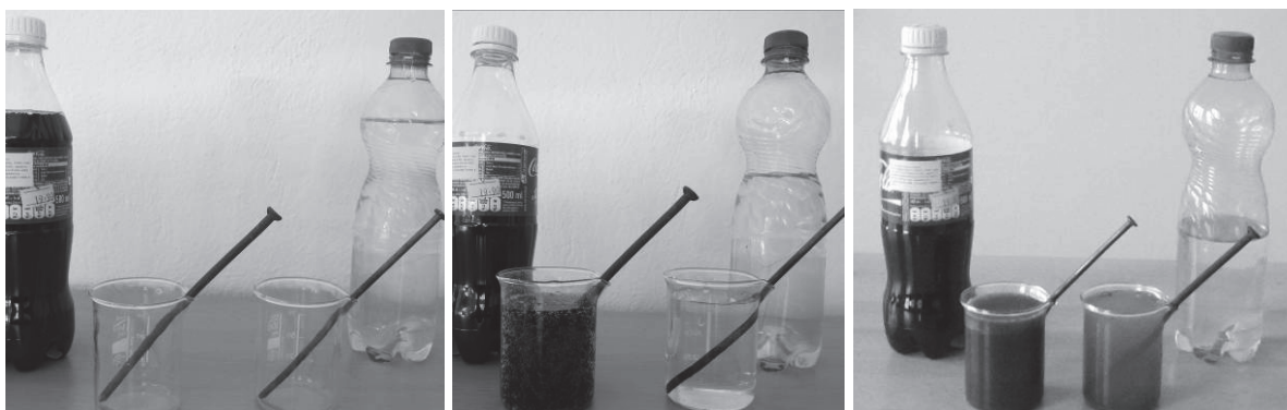
Obr. 6. Průběh experimentu Coca-cola: ochrana proti korozi.
