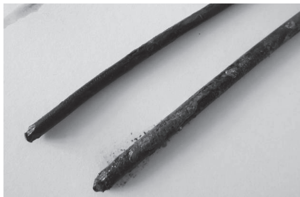
Obr. 7. Detaily hřebíků (levý Coca-cola, pravý voda).
