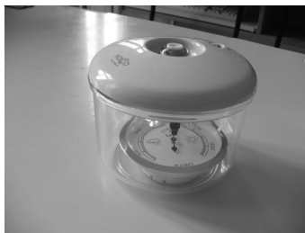
Obr. 4. Barometr v nádobě
