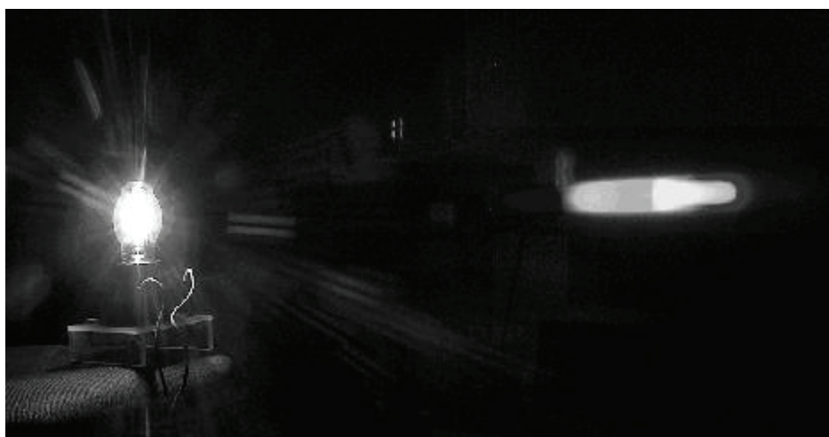
Obr. 5. Spojité spektrum halogenové žárovky
