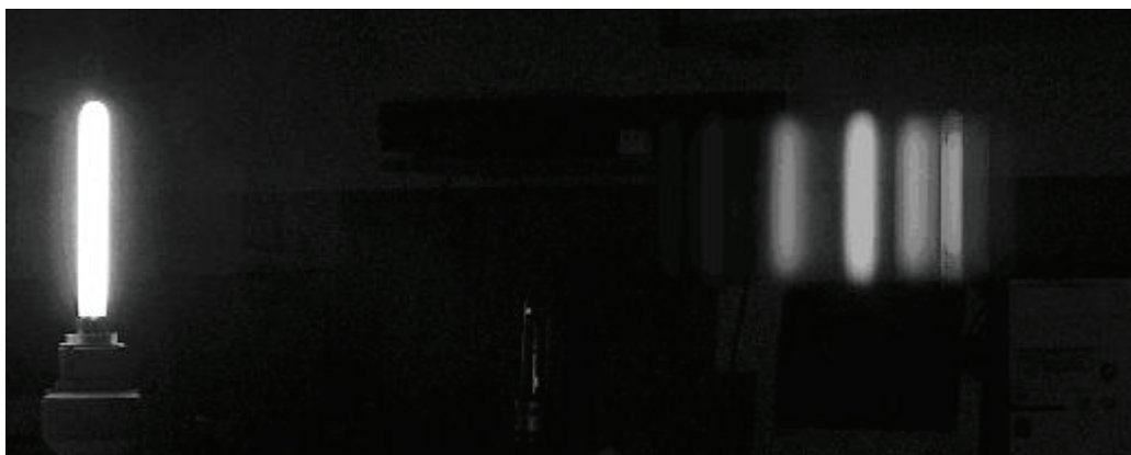
Obr. 7. Spektrum lineární zářivky
