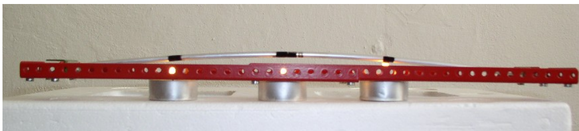
Obr. 6. Deformace tyčinky (háčku) po zahřátí. (Před zahříváním byla opravdu téměř rovná.)
