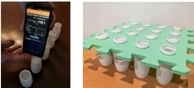
Obr. 3 Vlevo – akustický model STM s pěti lahvičkami (atomy), telefon s viditelnou obrazovkou je přijímač, druhý telefon (skrýtý za prvním) je vysílač, mikrofón přijímače a reproduktor vysílače se nacházejí v těsné blízkosti kelímků, vpravo – matice lahviček (atomů) 4×4 s pěnovou šablonou
