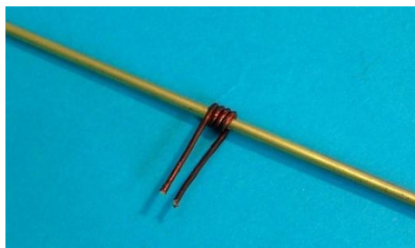
Obr. 3 Úprava upnutí středu vzorku
