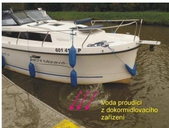
Obr. 10 Zkouška dokormidlovacího zařízení na kajutové lodi na Bat'ově kanálu
