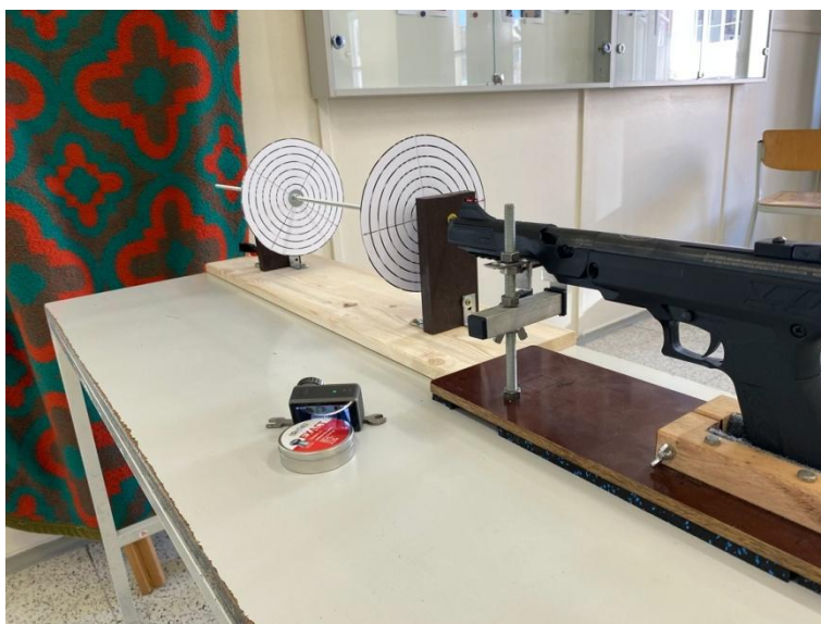
Obr. 5 Aparatura rotujících kotoučů k měření rychlosti
