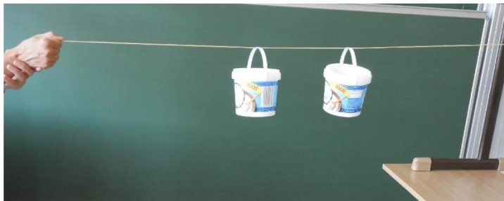
Obr. 6 Sprážená kyvadla realizovaná plastovými kbelíky na gumě
