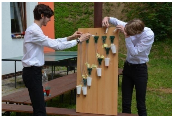
Obr. 7 Ukázka činnosti binární vodní sčítačky
