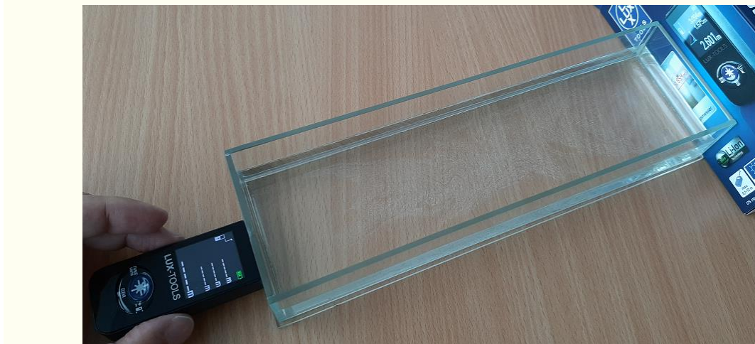
Obr. 2. Základní uspořádání experimentu pro měření indexu lomu kapaliny – měřič je umístěn těsně u stěny nádoby (zvnějšku), v nádobě je měřená kapalina, těsně u protější stěny nádoby je překážka (zvnějšku, např. krabíčka), od které se signál odrazí zpět.
