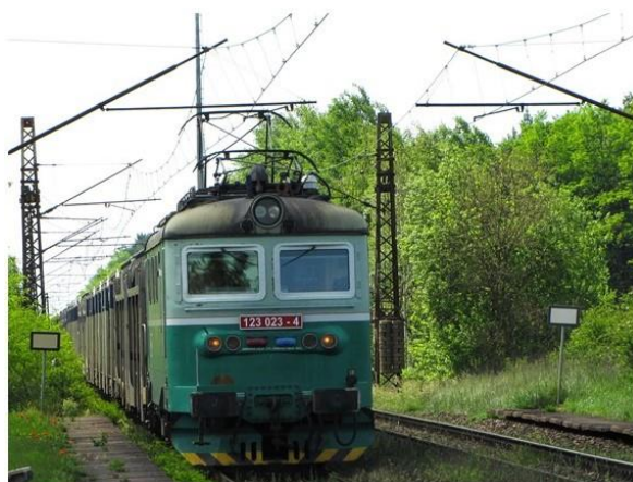
Obr. 1. Jednovodičové napájecí vedení nad železniční tratí a dvouvodičové trolejbusové vedení.
