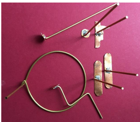
Obr. 1. Vyrobené různé elektrody na demonstraci elektrického pole.
