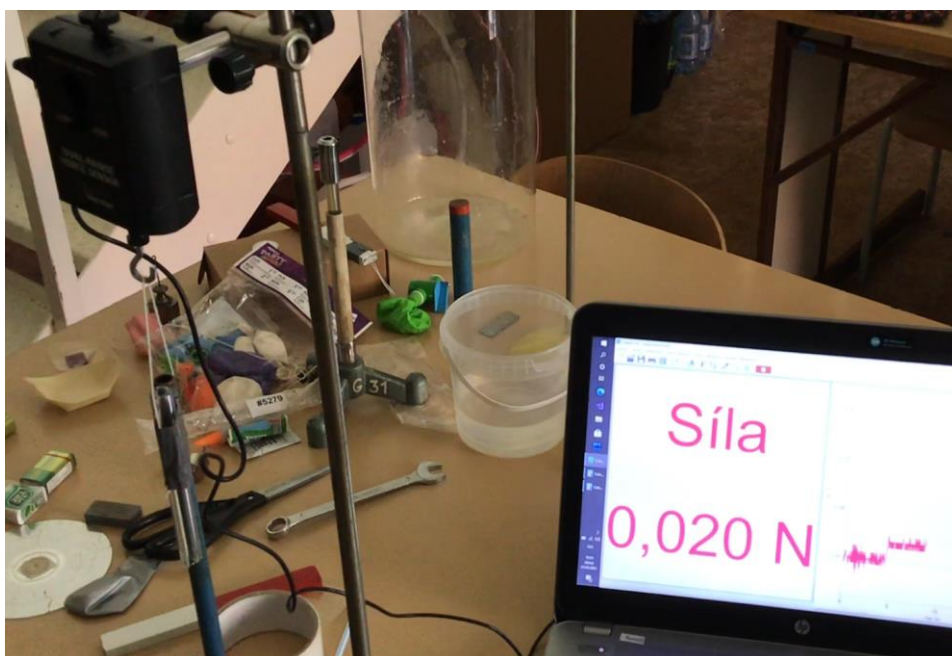
Obr. 2. Uspořádání experimentu s magnetem padajícím trubcí
