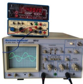
Obr. 2. Generátor napětí GBF 100 a dvoukanálový osciloskop.
