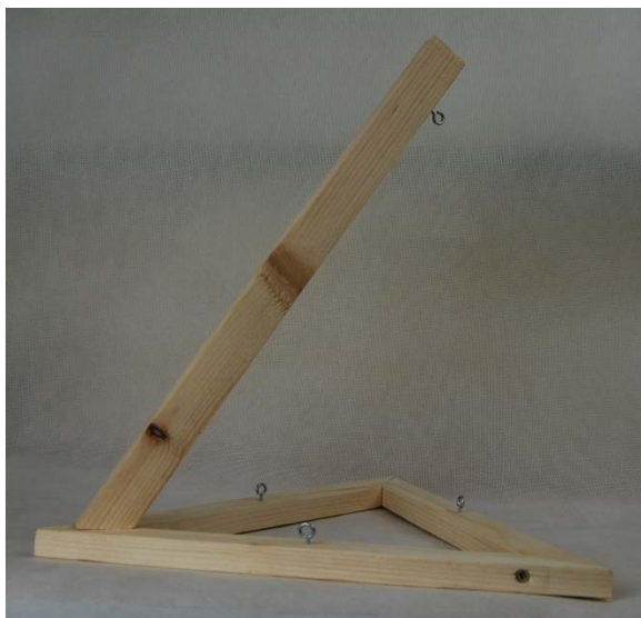
Obr. 16. Polovina tensegrity (již s připevněnými očky).
