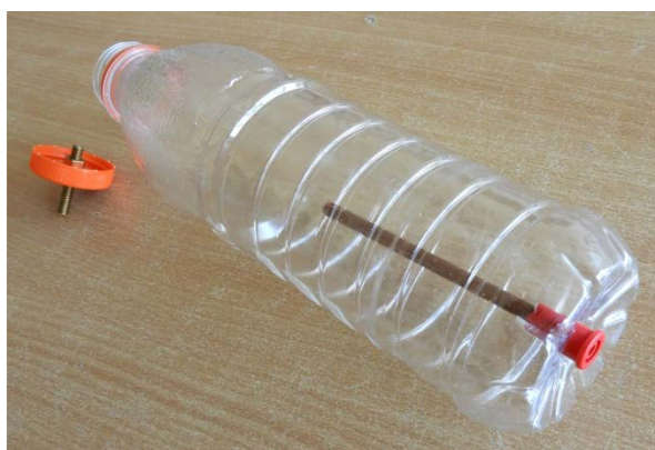
Obr. 11. Odlučovač kouře.
