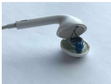
Obr. 3. Pohled na elektroakustický měnič (EAM).
