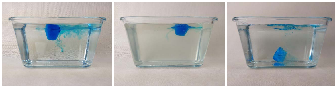
Obr. 4. Nádobu s vodou po vhození kostky ledu, vlevo sladká voda, uprostřed slaná voda, vpravo sladká voda s kostkou ledu s vloženou maticí.
