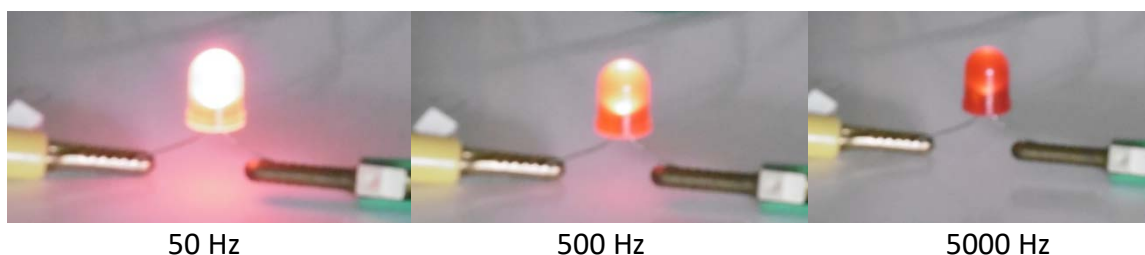
Obr. 6. Jas LED zapojené sériově s cívkou při různých frekvencích zdroje.
