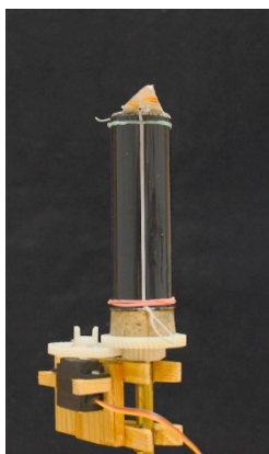
Obr. 10. Váleček s turbulátorem.
