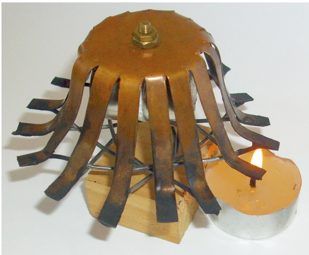
Obr. 13. Motor z termočláneků
