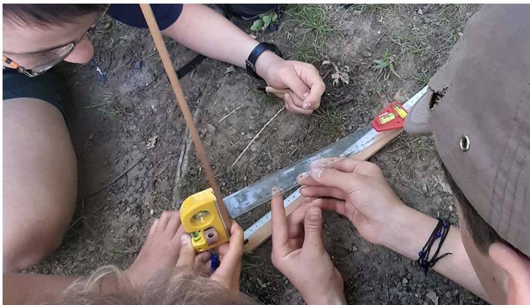
Obr. 4. Měření vedoucí k určení strmosti svahu (základem je pravoúhlý trojúhelník – vodorovná a svislá strana je hledána pomocí vodováhy).
