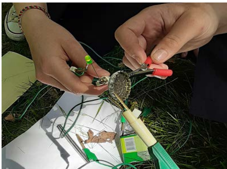
Obr. 1. Jedno ze správných zapojení obvodu – s využitím kovové zátky.
