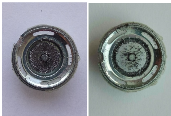
Obr. 16. Zkoumání magnetického pole uvnitř reproduktoru pomocí železných pilin.
