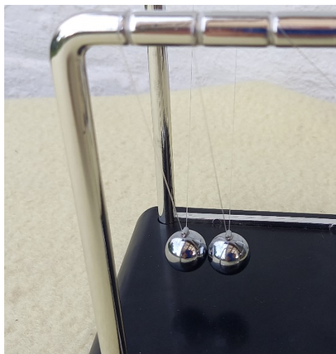
Obr. 1. Model srážky neutronu s protonem demonstrováný na rázostroji. Přilétající koule se zastaví a nehybná odletí téměř stejnou rychlostí.
