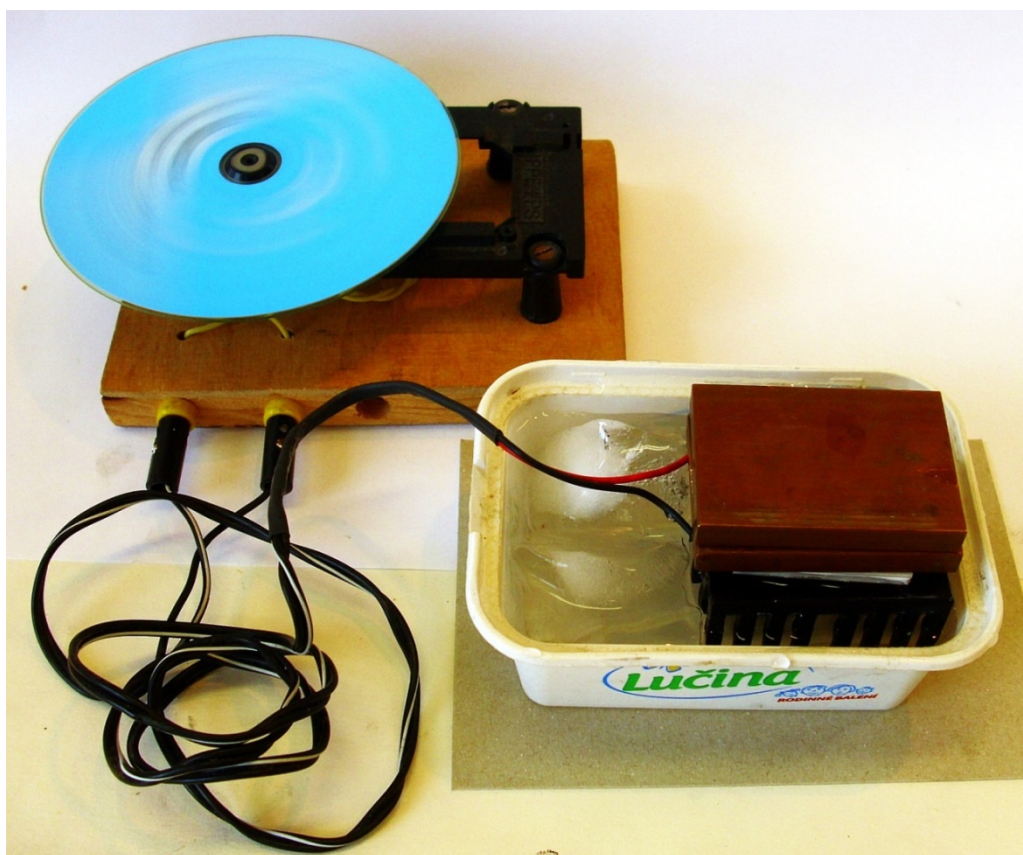
Obr. 10. Peltier leží na chladiči z počítače. Chladič je ponořen do ledové vody, která ho udržuje na nízké teplotě. Navrchu leží dva měděné hranoly, které byly původně ohřáty v horké vodě na teplotu cca 50 °C. V tomto uspořádání dává Peltier napětí cca 1,3 V a proud okolo 150 mA.
