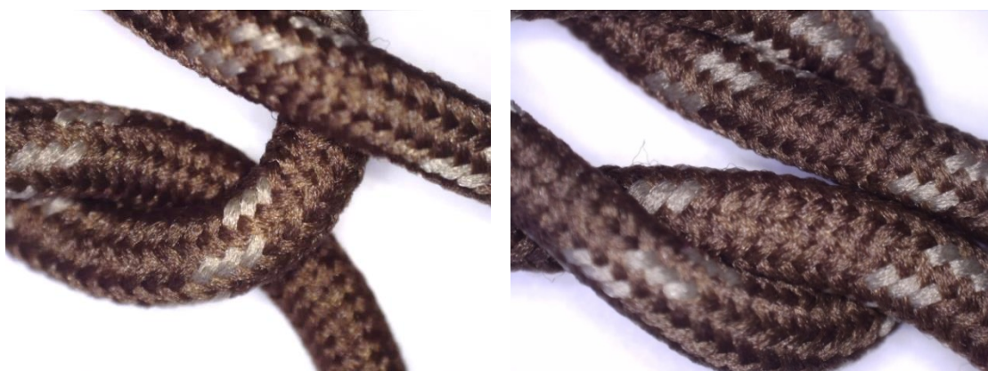
Obr. 6. Křížový a starobabský uzel pod mikroskopem.
