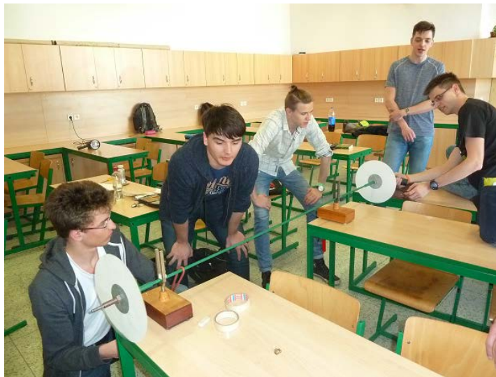
Obr. 13. Měření rychlosti střely pomocí dvojice rotujících kotoučů.
