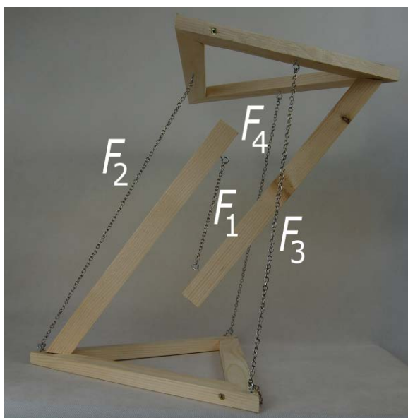
Obr. 22. Síly působící v tensegritě.
