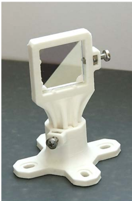
Obr. 12. Zkompletovaný modul děliče paprsků.
