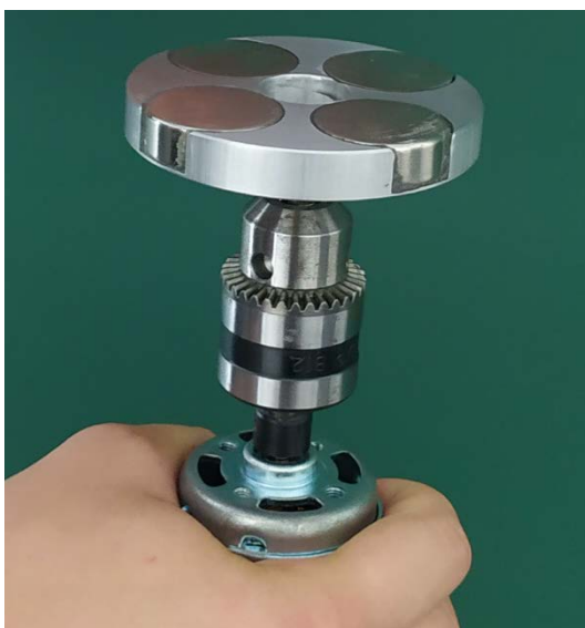
Obr. 4. Disk s magnety upevněný k motoru.
