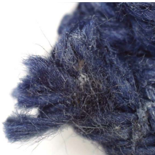
Obr. 8. Struktura tkaničky pod USB mikroskopem (zvětšeno 20×).
