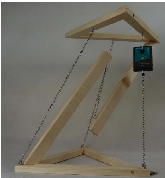
Obr. 21. Dřevěná tensegrita s připevněným siloměrem.
