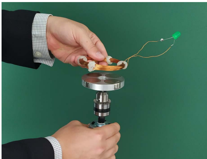
Obr. 5. Na cívce nad rotujícím kotoučem se v tomto případě nenaindukuje napětí.
