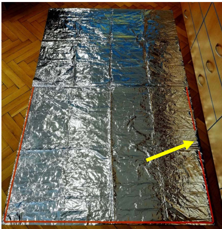
Obr. 1. Výroba balónu – šipkou je označené místo, kde bude otvor pro nafukování.
