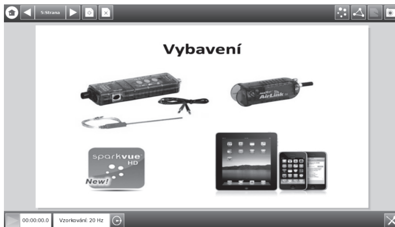
Obr. 1. Senzory (vlevo nahoře) komunikují s tablety prostřednictvím rozhraní bluetooth (vpravo nahoře), data jsou vyhodnocena v SW SPARKvue HD.
