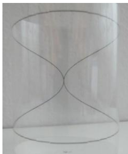
Obr. 7 Lissajousova křivka poměr frekvencí 2:1
