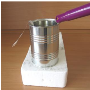
Obr. 7 Nabíjení plechovky magickou hůlkou
