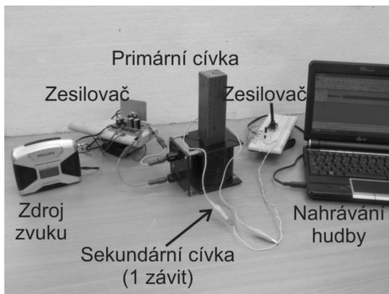
Obr. 2 Uspořádání experimentu „Netradiční transformátor“
