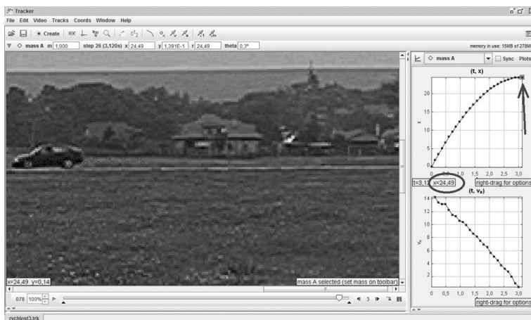
Obr. 2 Zo závislosti polohy automobilu od času zistíme jeho brzdnú dráhu, v našom prípade približne 25 m
