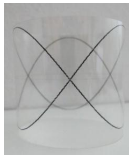
Obr. 8 Lissajousova křivka poměr frekvencí 2:3
