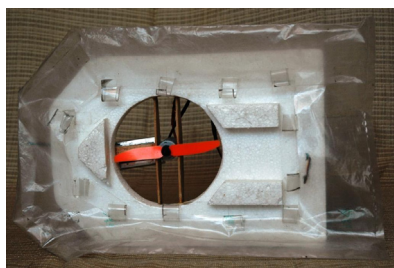
Výřez v sukni a PS distanční podložky
