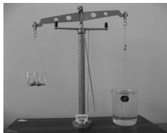
Obr. 6. HV s náhradní miskou na závaží
