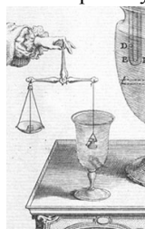
Obr. 1. Hydrostatické váhy
