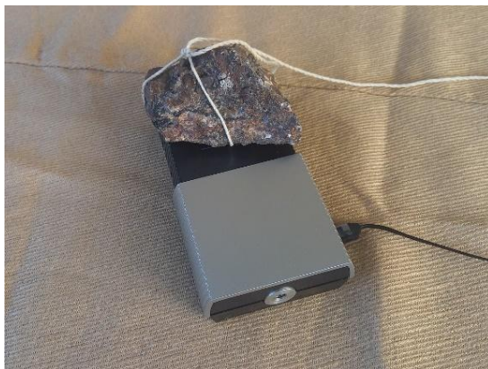
Obr. 3 Kámen s uranovou rudou na detektoru MX-10
