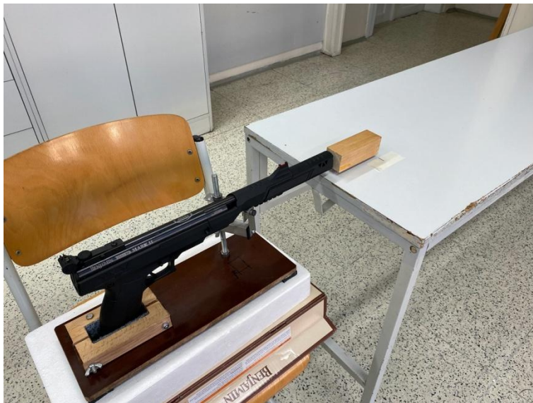
Obr. 3 Měření pomocí posunu dřevěného kvádrů
