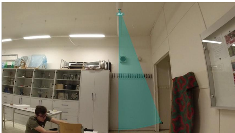
Obr. 4. Vychýlení kyvadla z rovnovážné polohy po výstřelu
