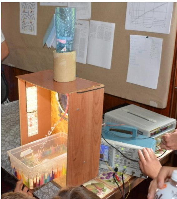
Obr. 5. Pomůcka k demonstraci „levitace vody“
