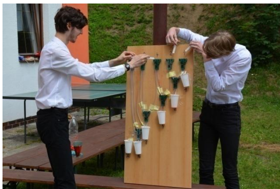
Obr. 7 Ukázka činnosti binární vodní sčítačky
