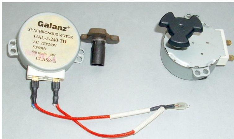
Obr. 5 Použitý motorek z mikrovlnky s připojenou doutnavkou z varné konvice
