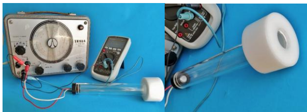
Obr. 11 Sestava pro plyny, detail uzavření membránou
