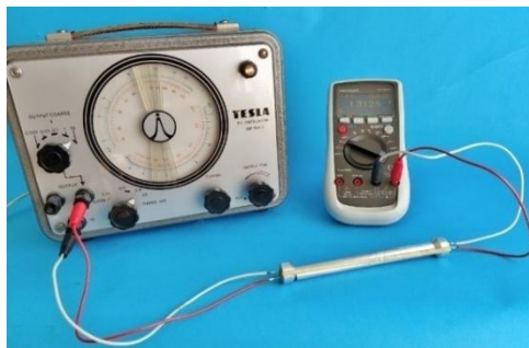
Obr. 4 Sestava měření v kovu
