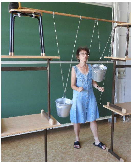
Obr. 3 Jeden závěs má stálou délku (kbelík vlevo), délku druhého měníme taháním za závěs (kbelík vpravo)
