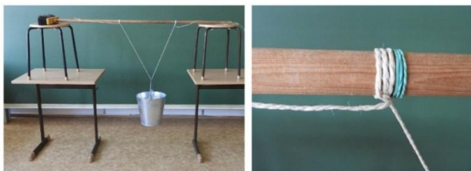
Obr. 2 Kbelík na bifilárním závěsu a detail uchycení závěsu ke smetáku
