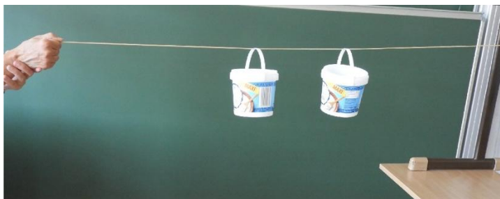
Obr. 6 Sprážená kyvadla realizovaná plastovými kbelíky na gumě
