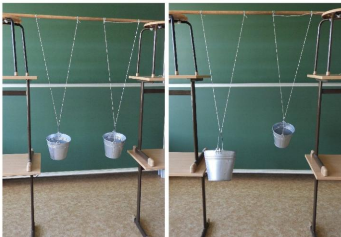
Obr. 4 Kbelíky kmitající ve fázi (vlevo) a s opačnou fází (vpravo)
