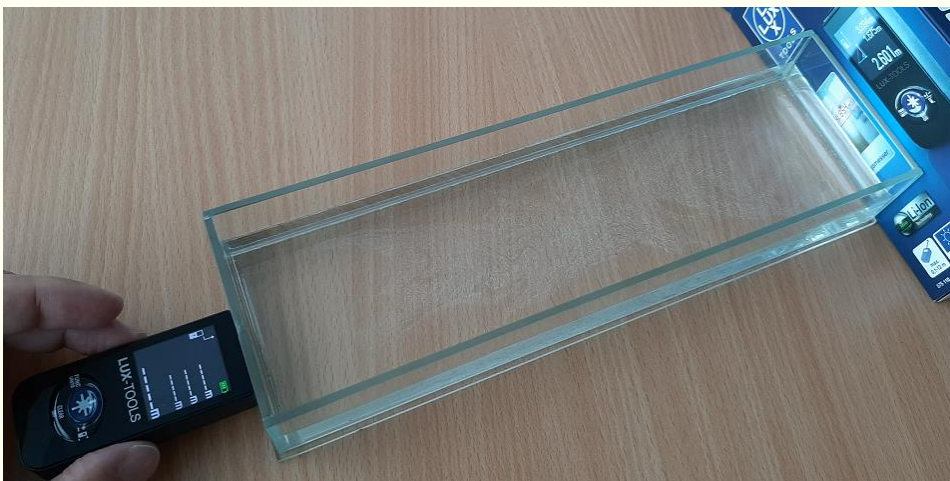
Obr. 2. Základní uspořádání experimentu pro měření indexu lomu kapaliny – měřič je umístěn těsně u stěny nádoby (zvnějšku), v nádobě je měřená kapalina, těsně u protější stěny nádoby je překážka (zvnějšku, např. krabička), od které se signál odrazí zpět.
