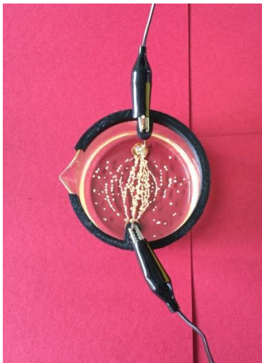
Obr. 3. Elektrické pole mezi dvěma nabitými tělesy kulového tvaru.
