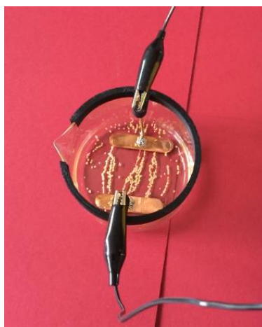
Obr. 4. Elektrické pole mezi deskami kondenzátoru.
