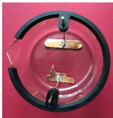
Obr. 2. Nízká kádinka a plastový nástavec s elektrodami.
