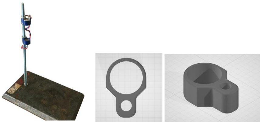
Obr. 4. Konstrukce a držáky na senzory.
