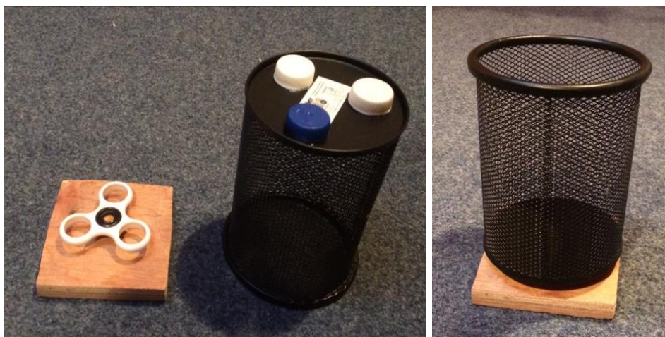
Obr. 4. Spinner je nasunut na bukovém kolíku vetknutém do překližkové destičky. Osazení košíku na spinner je provedeno plastovými vršky od mléka.
