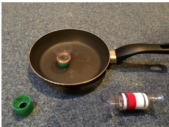
Obr. 6. Ukazuje vybavení pro svařování PE vršků
