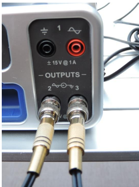
Obr. 13. Použití speciálních redukci k připojení nízkofrekvenčních výstupních kabelů.
