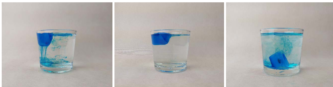
Obr. 1. Nádoba s vodou po vhození kostky ledu, vlevo sladká voda, uprostřed slaná voda, vpravo sladká voda s kostkou ledu s vloženou maticí.
