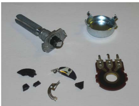
Obr. 7 Vymontovaná odporová ploška 10k
