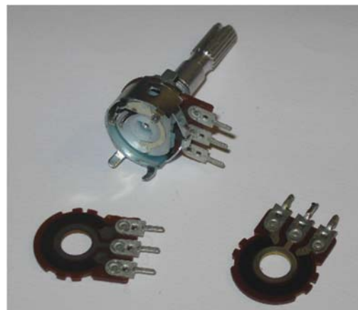
Obr. 8 Nahrazení odporové plošky ve stereo potenciometru
