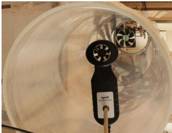
Obr. 2 Měření rychlosti vzduchu v rouře v závislosti na úhlové frekvenci vrtule
