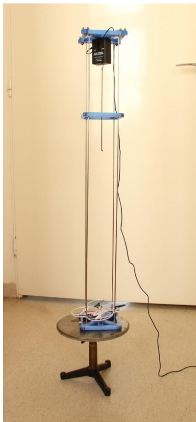
Obr. 7: Dron ve vodičí kleci pro měření
