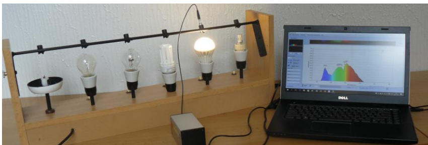
Obr. 4 Měření spekter světelných zdrojů
