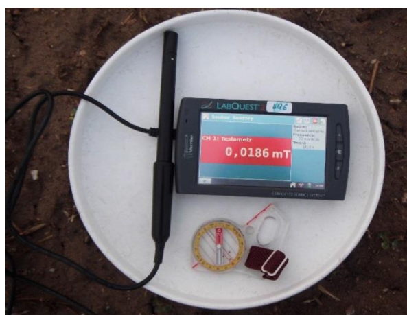
Obr. 4. Měření vertikální složky magnetické indukce (vlevo) a horizontální složky magnetické indukce (vpravo) teslametrem Vernier. Vpravo má sonda směr magnetického poledníku.
