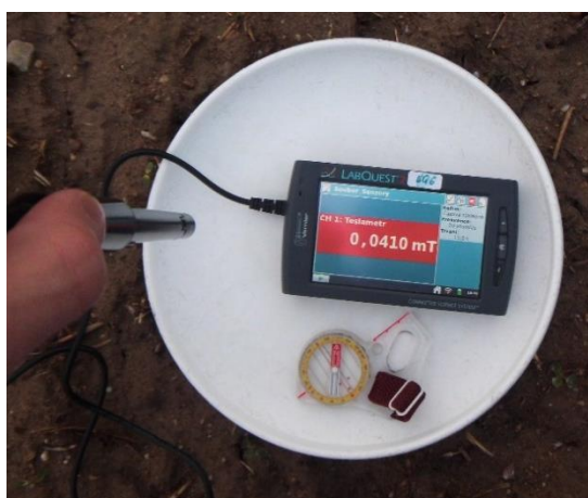
Obr. 4. Měření vertikální složky magnetické indukce (vlevo) a horizontální složky magnetické indukce (vpravo) teslametrem Vernier. Vpravo má sonda směr magnetického poledníku.
