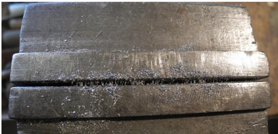
Obr. 1. Železné piliny na čelistech svěráku.
