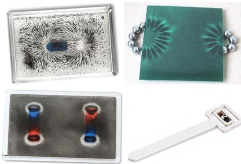
Obr. 1. Zkoumání magnetického pole pomocí: železných pilin, senzorové fólie, detekční destičky, snímače magnetického pole.
