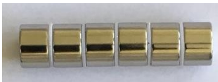
Obr. 4. Válcový magnet poskládaný z 6 neodymových magnetů (jeden magnet má průměr 15 mm, výška 10 mm)
