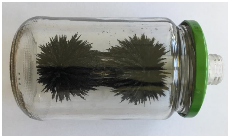
Obr. 3. Detekční nádoba ze zavařovací sklenice
