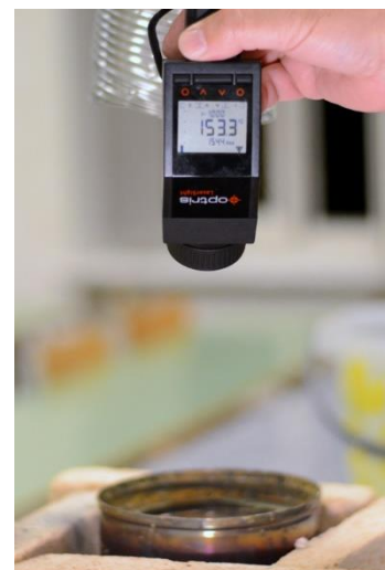
Obr. 5. Údaj infračerveného teploměru pro olovo o teplotě dle obr. 4
