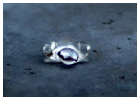
Obr. 3. Kmitající kapka vody na ocelové pánvi
