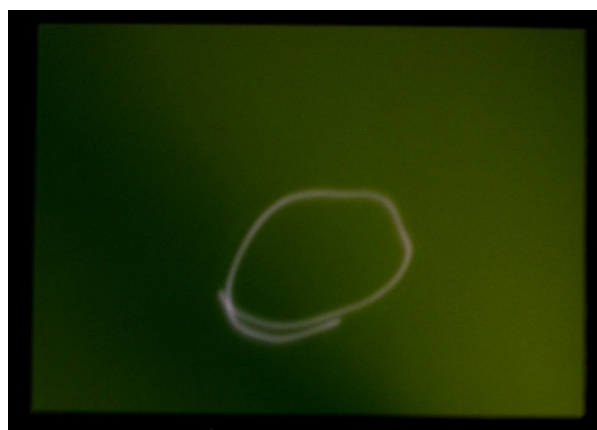
Obr. 6. Fotografie stopy infračerveného laseru (980 nm) na setrvale luminiskujícím papíře.
