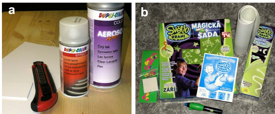
Obr. 8. Některé setrvale luminiskující pomůcky: (a) Sprej lze aplikovat na bílé desky z PVC (snadno dělitelné nožem) a případně překrýt bezbarvým lakem, (b) sada Světlohraní od Albi.
