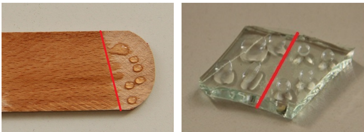
Obr. 5. a, b. Dřevo a sklo opracované v plazmatu (vždy levá část oddělena červenou čarou byla opracována v plazmatu) a kapky vody
