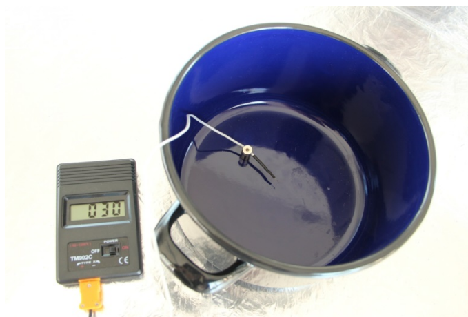
Obr. 3. Umístění termočlánu na dno hrnce pomocí dvou neodymových magnetů.
