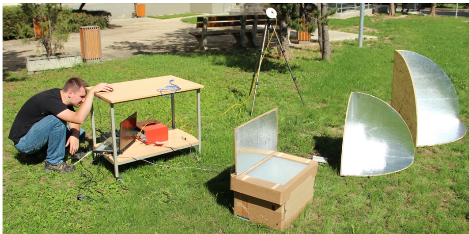
Obr. 2. Testování slunečních vaříčů na PdF MU. Data byla snímána automaticky po 1 minutě a ukládána do laptopu.
