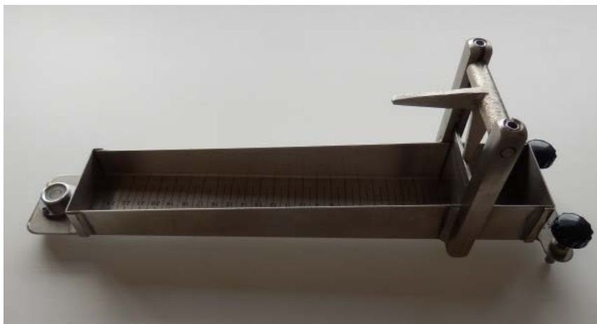
Obr. 2. Bostwickův konzistometr – pohled z boku
