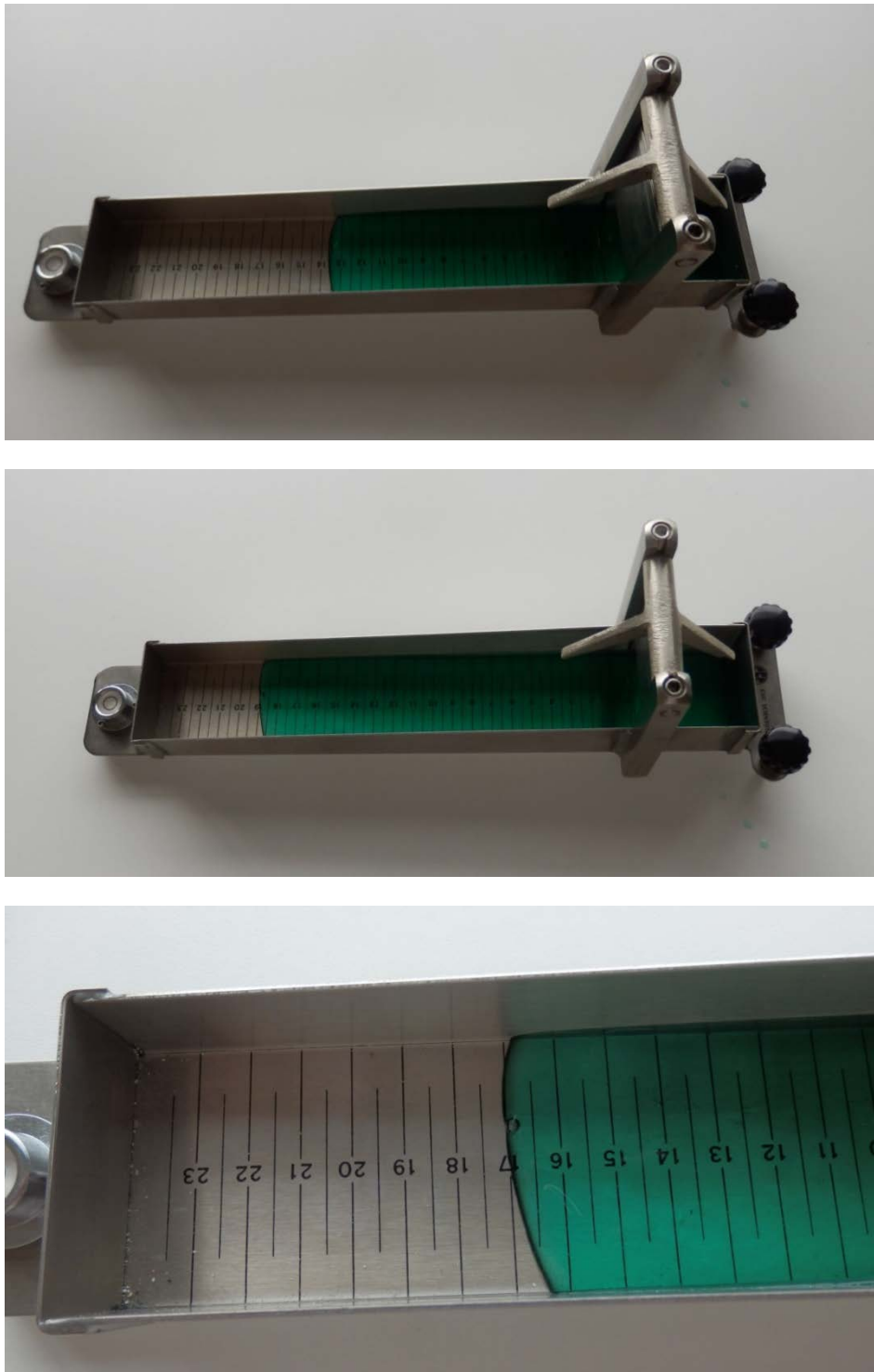
Obr. 3. Měření konzistivity koupelové pěny
