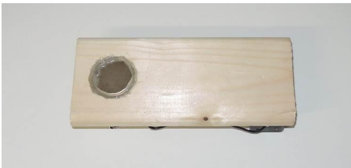
Obr. č. 3 Homopolární motor zespod – nyní je již neodymový magnet vidět
