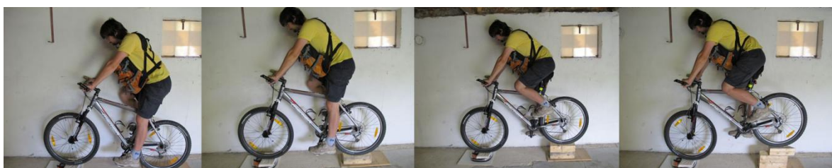
Obr. 3 - Fotografie z měření polohy těžiště jízdního kola s cyklistou – zátěž na břicho
