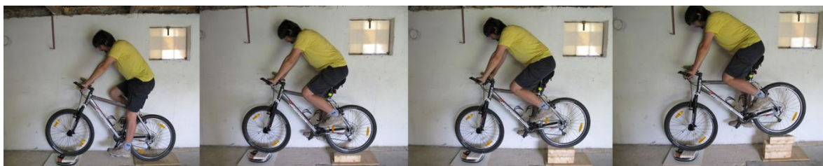
Obr. 1 - Fotografie z měření polohy těžiště jízdního kola s cyklistou – bez zátěže
