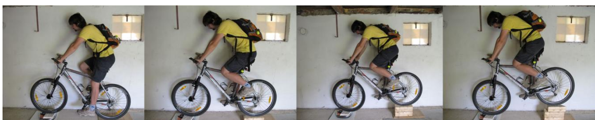
Obr. 2 - Fotografie z měření polohy těžiště jízdního kola s cyklistou – zátěž na zádech
