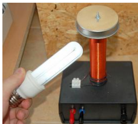
Obr. 3 – Schéma Teslova transformátoru a jeho realizace
