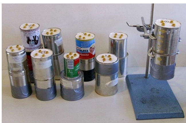
Obr. 5 - Detail konstrukce ionizační komory a komory, které vyrobili studenti 3. ročníku při práci v rámci fyzikálního semináře
