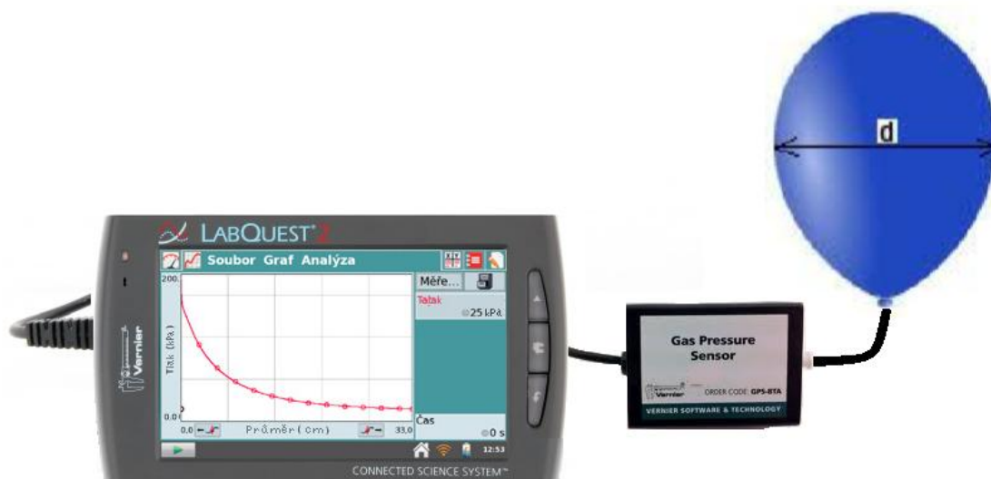
Obr. 4 - Měření závislosti přetlaku plynu na průměru balónku
