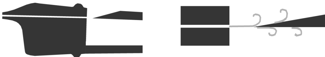
Obrázok 1 - Vľavo: rez hlásničkou zobcovej flauty. Vpravo: kanálikom fúkame prúd vzduchu na ostrú hranu za vzniku vírov.
