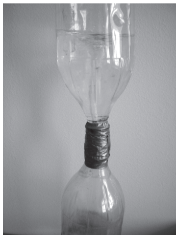
Obr. 6. Model tornáda v PET lahvích.
