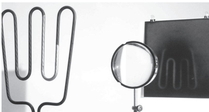
Obr. 4. Obraz zapalovače dřevěného uhlí. Povrchová teplota zdroje 500 \text{ }^\circ\text{C} , čočka s průměrem 12 cm a ohniskovou délkou 24 cm, přibližně symetrické uspořádání polohy předmětu a obrazu. Postříbřená část je kontrastnější než ostatní části (viz dále).
